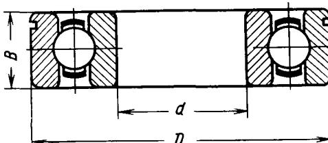
Шариковый радиальный однорядный с канавкой для стопорной шайбы на наружном кольце
